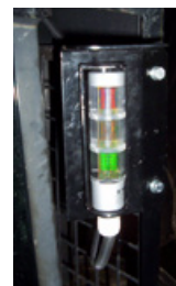
2 Měřicí prvek DW-3 a signální LED světla pro indikaci stavu nakládky
